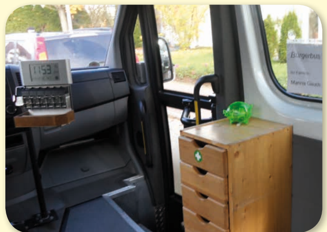
Bild 13: Nützliche Ausrüstung: Kassiertisch, Uhr, Fahrernamensschild, Ablage und Spendendose (hier im Bürgermobil Bad Wimpfen, Foto: Martin Schiefelbusch)
