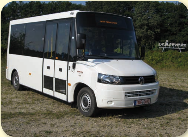
Bild 14: Niederflur-Bürgerbus, umgebaut aus einem VW-Transporter - im Einsatz etwa in Bad Krozingen und Furtwangen (Foto: Georg Bergmann, Fibe Bus GmbH)
