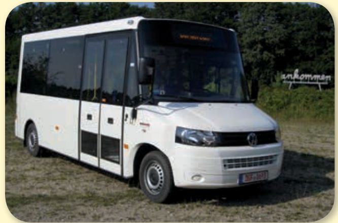
Bild 14: Niederflur-Bürgerbus, umgebaut aus einem VW-Transporter - im Einsatz etwa in Bad Krozingen und Furtwangen (Foto: Georg Bergmann, Fibe Bus GmbH)
