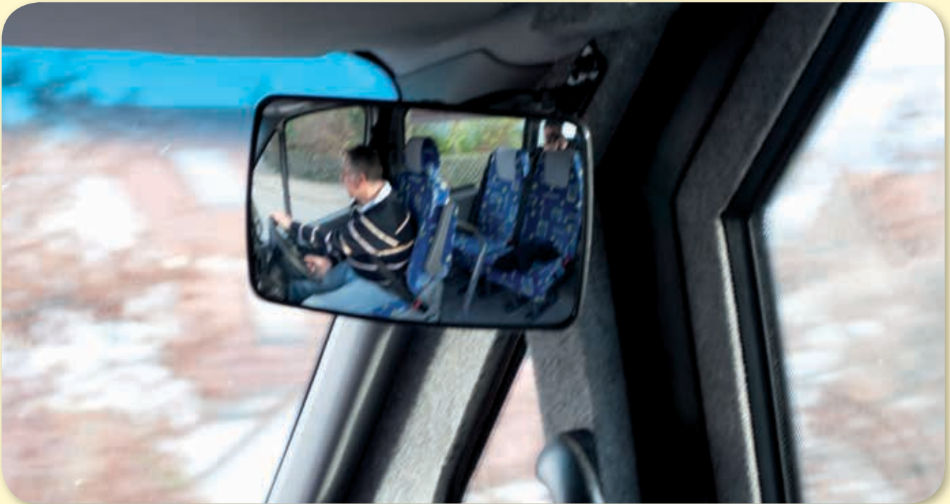
Bild 11: Zusatzspiegel schaffen besseren Überblick.
