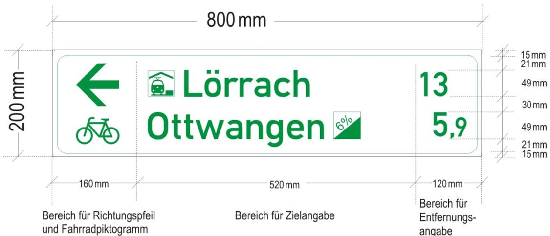
Abbildung 5-7 Tabellenwegweiser „Standardtyp“ 800 X 200 mm
